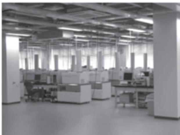
この研究所の目玉は、キャピラリー電気泳動装置と質量分析計、コンピューターを組み合わせたメタローム解析システムである。一台 5000 万円もするというこの装置が 20 台ほど並んでいる様子は圧巻であった。研究所にはこの技術を利用するさまざまな研究室がある。オイルを生産する藻を生産する研究、クモの糸を人工的に生産するベンチャー企業「スパイバー」のラボなど、さまざまな施設を見学した。
